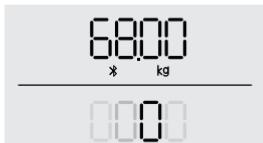
La medición del peso estará completa cuando la indicación parpadee dos veces y se quede fija. El análisis corporal estará completo cuando el número 0 deje de moverse de izquierda a derecha en la pantalla.
