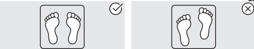
Para medir correctamente la grasa y otros parámetros de la composición corporal, póngase de pie sobre la báscula situando los pies encima de los electrodos (según se muestra en la figura) ubicados en ambos lados de la báscula.
