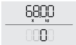
Se il numero lampeggia due volte, significa che la misurazione del peso è completa. Quando il numero 0 smette di muoversi da sinistra a destra attraverso lo schermo, significa che l'analisi corporea è completa.
