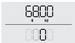
Si le nombre clignote deux fois, cela veut dire que la mesure du poids est conclue. Lorsque le chiffre 0 arrête de défilez de gauche à droite de l'écran, cela veut dire que l'analyse corporelle est complète.
