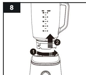
8. Ruotare il vaso in vetro in senso antiorario e rimuoverlo.
