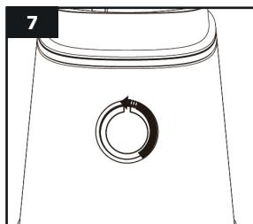
7. Ruotare la manopola di regolazione della velocità in senso antiorario per interrompere il funzionamento.
