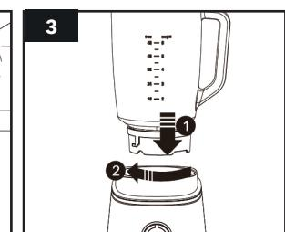
3. Platzieren Sie den gefüllten Glasbehälter auf das Klingensystem, indem Sie ihn im Uhrzeigersinn drehen. Der Motor darf erst gestartet werden, wenn der Glasbehälter sicher positioniert wurde.
