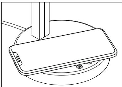
Vous pouvez charger votre téléphone compatible Qi en le plaçant sur la **zone de chargement sans fil** située sur le socle de la lampe. Pour le charger sans fil, placez votre appareil sur l'icône de chargement au centre du socle. L'appareil doit être placé directement au-dessus
