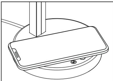
Puede cargar un teléfono compatible con la tecnología Qi colocándolo en el **Área de carga inalámbrica** de la base del flexo. Para cargar de forma inalámbrica, coloque su dispositivo sobre el icono de carga situado en el centro de la base. El dispositivo debe colocarse directamente sobre el icono para un funcionamiento óptimo de la función de carga. Tenga en cuenta que puede ser necesario activar la carga inalámbrica en los ajustes de su dispositivo.
