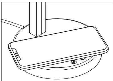
O seu telemóvel compatível com Qi pode ser carregado ao colocá-lo sobre a **Área de Carregamento Sem Fios** na base do candeeiro. Para carregar sem fios, coloque o seu dispositivo sobre o ícone de carregamento no centro da base. O dispositivo deve ser colocado diretamente sobre o ícone da função de carregamento para funcionar de forma ideal. Note que pode ser necessário ativar o carregamento sem fios nas definições do seu dispositivo.
