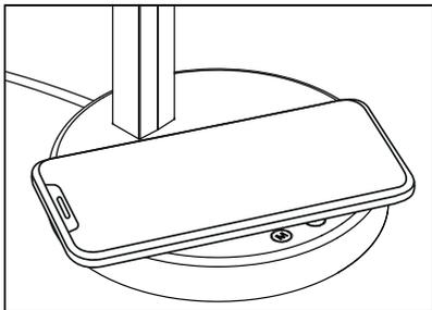
È possibile ricaricare telefoni compatibili con tecnologia Qi posizionandoli nella **Area di ricarica wireless** sulla base della lampada. Per ricaricare in modalità wireless, posizionare il dispositivo sopra l'icona di ricarica al centro della base. Per un funzionamento ottimale della funzione di ricarica, il dispositivo deve essere posizionato direttamente sopra l'icona. Potrebbe essere necessario attivare la ricarica senza fili nelle impostazioni del dispositivo.
